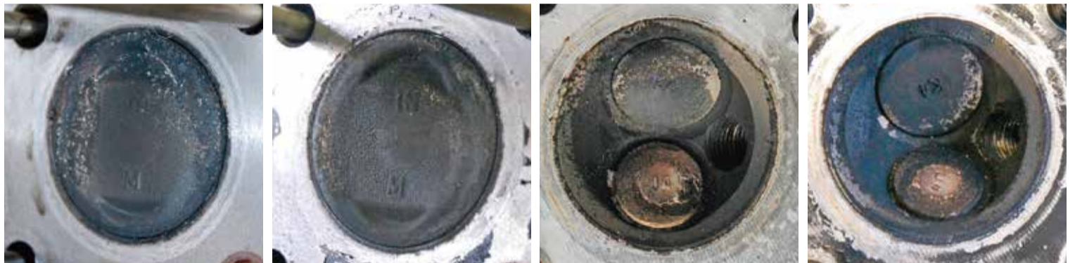
7月5日混入前：カーボンのデポジットでほぼ全ピストンヘッド
